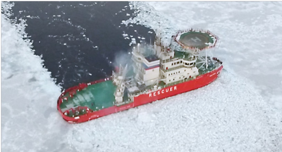
Kuva 6.1. Vino jäämurtaja (oblique icebreaker) Kuva: Arctech Helsinki Shipyard Oy
