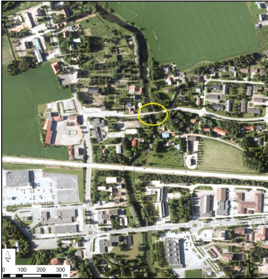
Kuva 36. Kirkkosilta (ympyröity keltaisella) sijaitsee Euran keskustan välittömässä läheisyydessä sen alajuoksun puolella. Kirkkosillan rakenteella on merkittävä vaikutus Euran keskustan vedenkorkeuksiin. Myös muut ihmisen tekemät rakenteet, kuten kuvan muut sillat ja laiturit, vaikuttavat veden virtaukseen uomassa.
