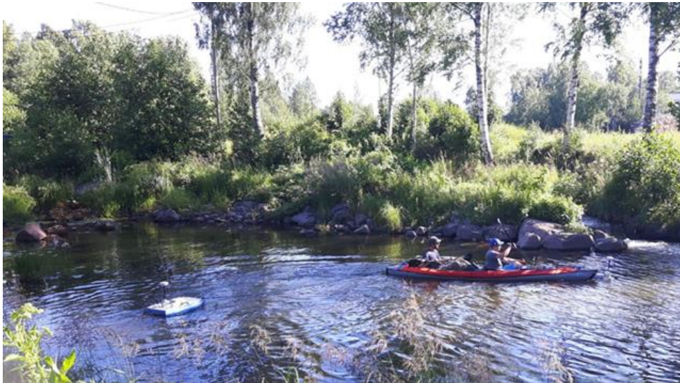
Kuva 28. ADCP kiinnitettynä kajakin keulaan sekä kelluvaan lauttaan, joka on pitkällä narulla kiinni kajakin perässä. Tällä yhdistelmällä melottiin tiheää "zigzag" kuviota koko uoman läpi reunasta reunaan (Kuva Linnea Blåfield).
