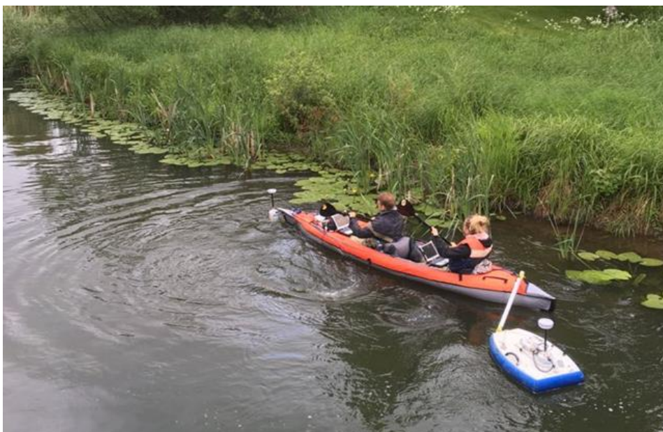
Kuva 27. Uoman pohjan geometria mitattiin kajakilla meloen yläjuoksulta kohti alajuoksua. Kajakin kärkeen oli kiinnitetty ADCP ja sivulle toinen ADCP kelluvaan lauttaan, noin metrin päähän kajakista. Tällä yhdistelmällä tehtiin kuusi suoraa pitkittäistä linjaa yläjuoksulta alajuoksulle. Uoman reunojen paikoin runsas kasvillisuus esti uoman todellisen reunan tavoittamisen (Kuva Santtu Kaipanen).
