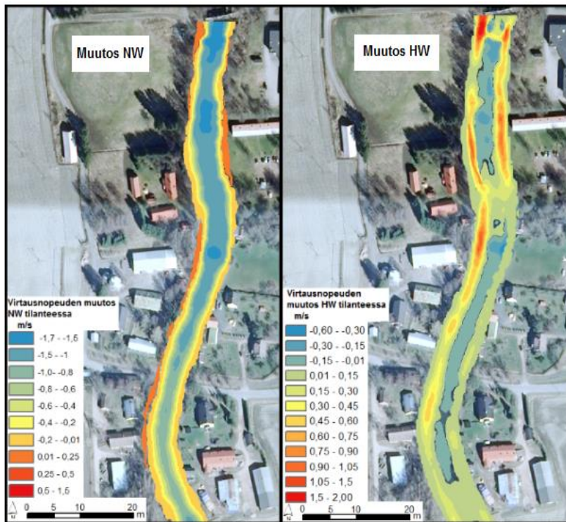
Kuva 68. NW nyk.- ja NW tul.- sekä HW nyk.- ja HW tul. - skenaarioiden virtausnopeuksien erotuskuva tutkimusalueen alaosaista Eurakosken padolta.
