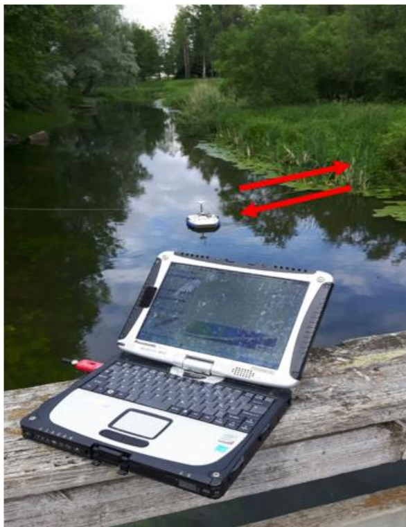
Kuva 30. Virtausprofiili mitattiin lauttaan kiinnitetyllä ADCP:llä, jota ohjattiin naruin uoman kummaltakin reunalta. Lauttaa liikutettiin hiljalleen uoman laidalta toiselle useita kertoja, jotta poikkileikkauksen virtausprofiili saataisi mitattua mahdollisimman tarkasti. Sensorin tulee olla virtausta vasten, kuva on otettu yläjuoksulta kohti alajuoksua (Kuva Linnea Blåfield).
