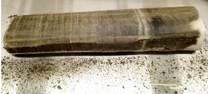
Kuva 6 Jääsorminäytteen Kalla3 käsittely aloitettiin tasoittamalla pinta puukolla.
