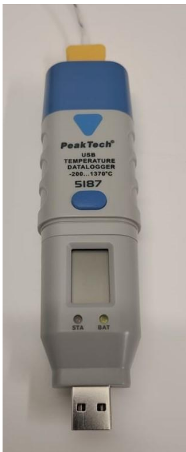
Kuva 1. K-tyyppin anturin lämpötilanmittauslaite PeakTech. Kuva: Henrik Paatsamala.
