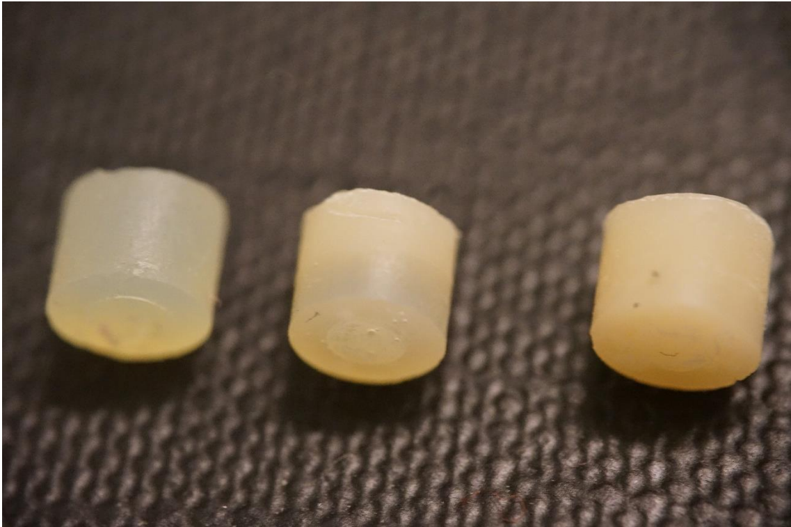
Kuva 14. Mittauksissa kovetetut yhdistelmämuovikappaleet pohjan suunnasta. Vasemmalta järjestyksessä GC everX Flow Bulk Shade, GC everX Flow Bulk Shade (2 mm) + GC G-aenial posterior P-A3 (2 mm) ja GC G-aenial posterior P-A3 (2 + 2 mm). Kuva: Henrik Paatsamala.
