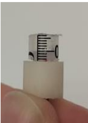
Kuva 7. Tutkimuksessa käytettävä testikaviteetti sivulta. Lämpöanturina K-typin termopari. Kuva: Henrik Paatsamala.
