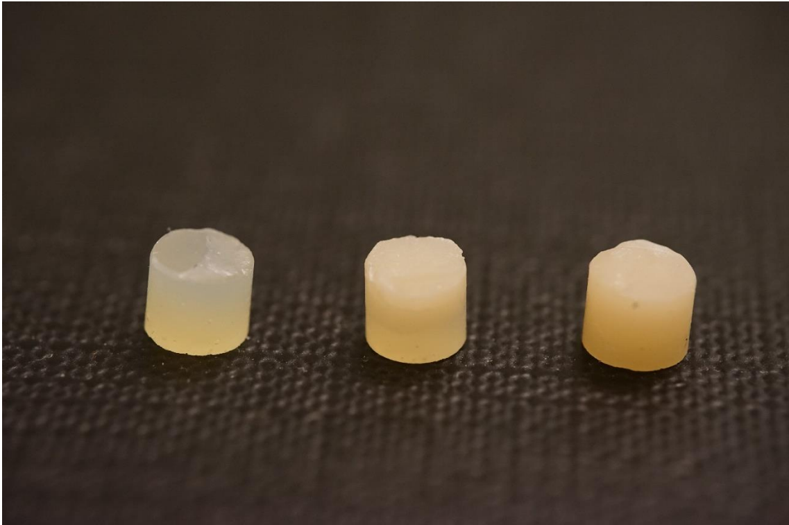
Kuva 13. Mittauksissa kovetetut yhdistelmämuovikappaleet sivuprofiilista. Vasemmalta järjestyksessä GC everX Flow Bulk Shade, GC everX Flow Bulk Shade (2 mm) + GC G-aenial posterior P-A3 (2 mm) ja GC G-aenial posterior P-A3 (2 + 2 mm). Kuva: Henrik Paatsamala.
