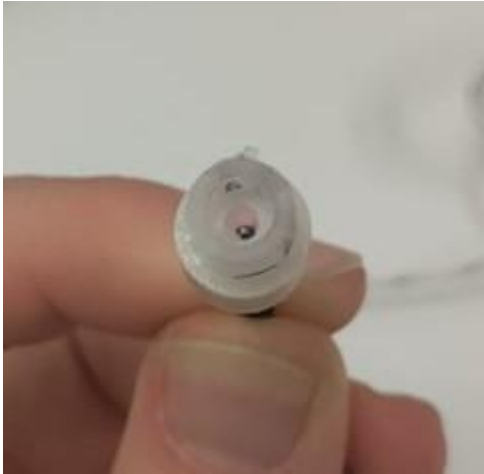
Kuva 8. Tutkimuksessa käytettävä testikaviteetti ylhäältä. K-tyypin lämpöanturi näkyy upotettuna testikaviteetin pohjatasoon. Kuva: Henrik Paatsamala.
