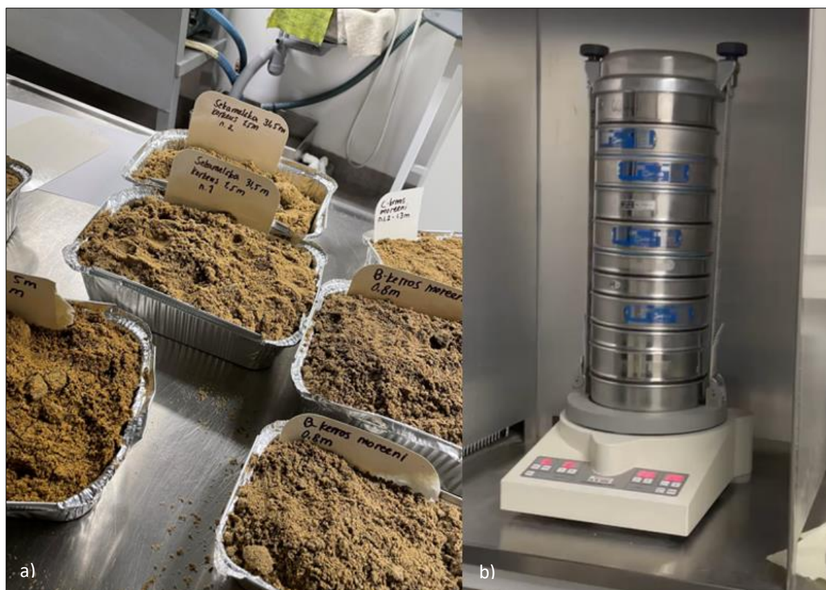
Kuva 13. Sedimenttinäytteet a) säilytettiin ja kuivattiin Turun geologian laitoksella, minkä jälkeen ne b) punnittiin ja kuivaseulottiin laitoksen laboratoriossa.
