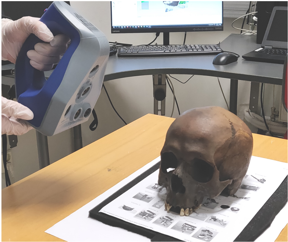
Kuva 20. O.-P. Puttonen skannaa kalloa Artec Space Spider -3D-skannerilla.
