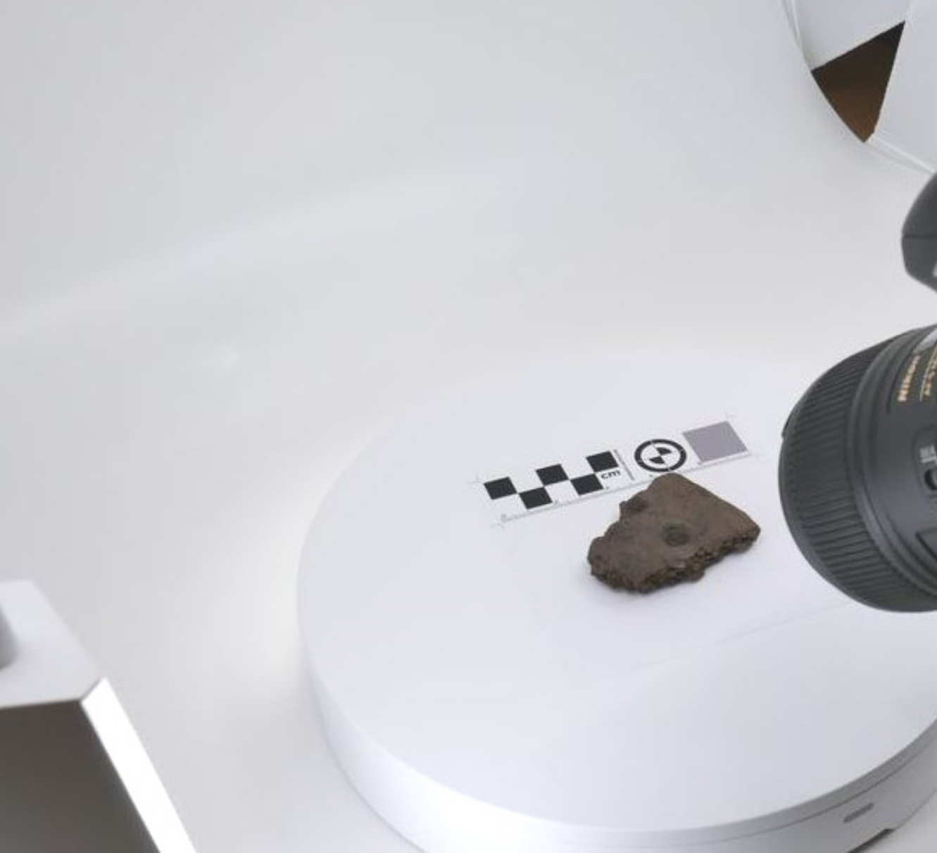
Kuva 1. Keramiikan kappaleen valokuvaamista fotogrammetrista 3D-digitointia varten.
