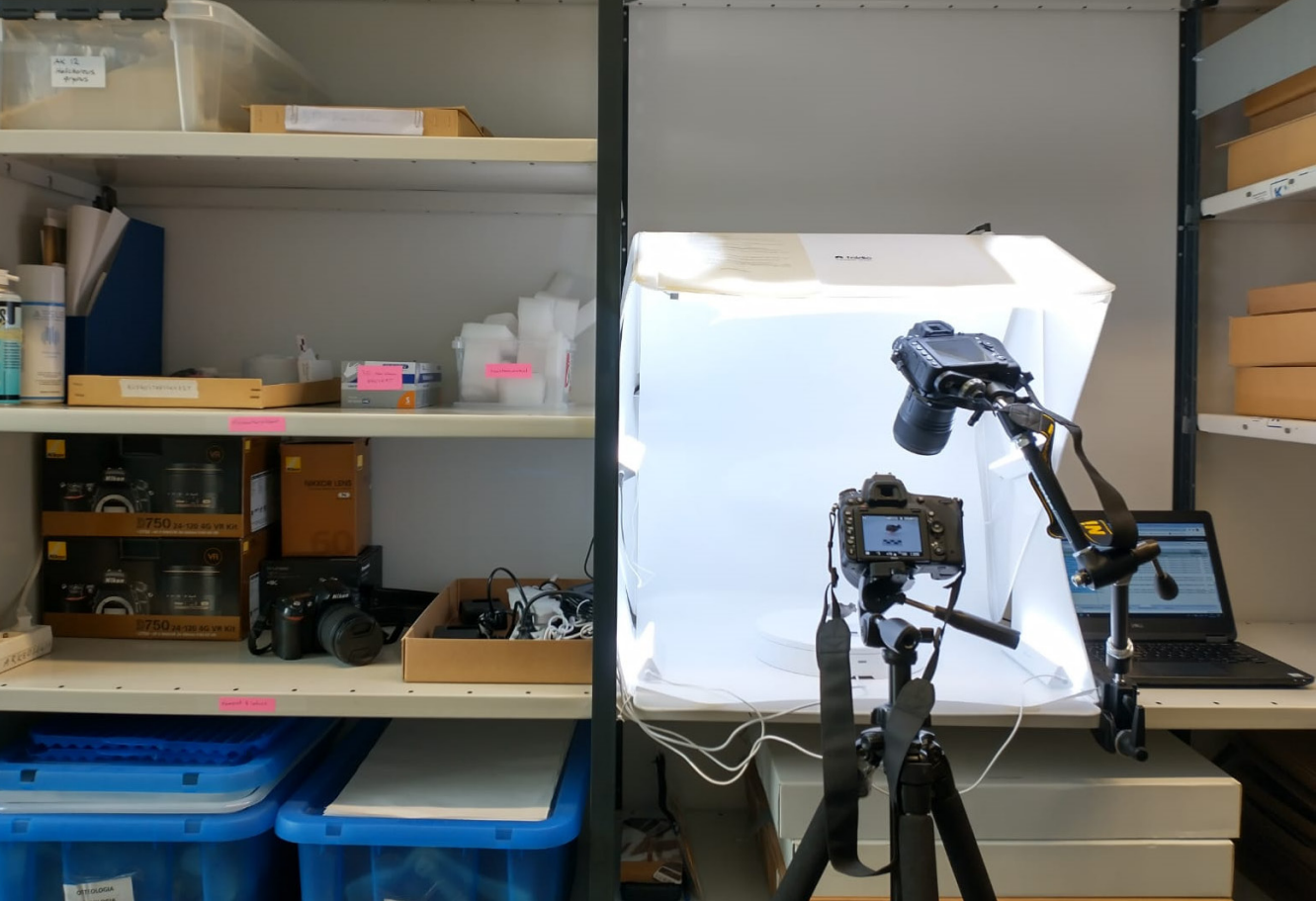
Kuva 7. 3D-digitointistudion ei tarvitse olla kookas, kunhan tilaa on tarvikkeille, valoteltalle ja digitoitaville löydöille. Kuvan Turun yliopiston arkeologian oppiaineen 3D-studiossa voi kuvata jopa 45 cm pitkiä löytöjä.
