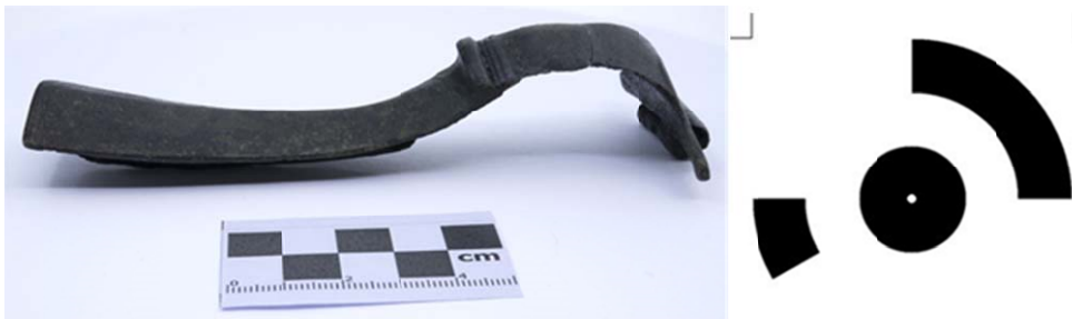
Kuva 1. Vasemmalla tavallinen mittakaava kuvaustasolla, oikealla automaattisesti tunnistettava markkeri.
