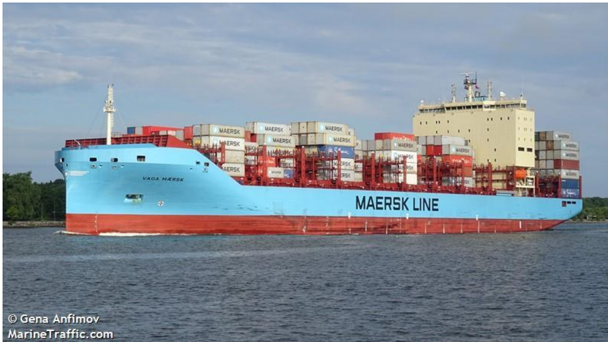
Kuvio 11 MS Vaga Maersk (3 593 TEU), yksi seitsemästä Maersk Linen ns. Jumbo Class -sarjan IA-luokan aluksesta, jotka ovat tällä hetkellä maailman suurimmat jäävahvistetut konttialukset. Näistä viisi liikennöi säännöllisesti Suomeen vuonna 2020. Kuva: MarineTraffic
