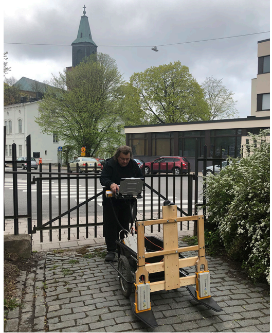
Kuva 2. Kirjoittaja testaamassa maatutkalaitteistoa ja -kärryä 11.5.2019. Etummaisena kärryssä on lähetin-vastaanotin-antennipari, keskellä tila tutkayksikköä ja varusteita varten sekä takana maastokannettava, joka toimii datankeräijänä. Kuva: Maiju Kinnunen.
