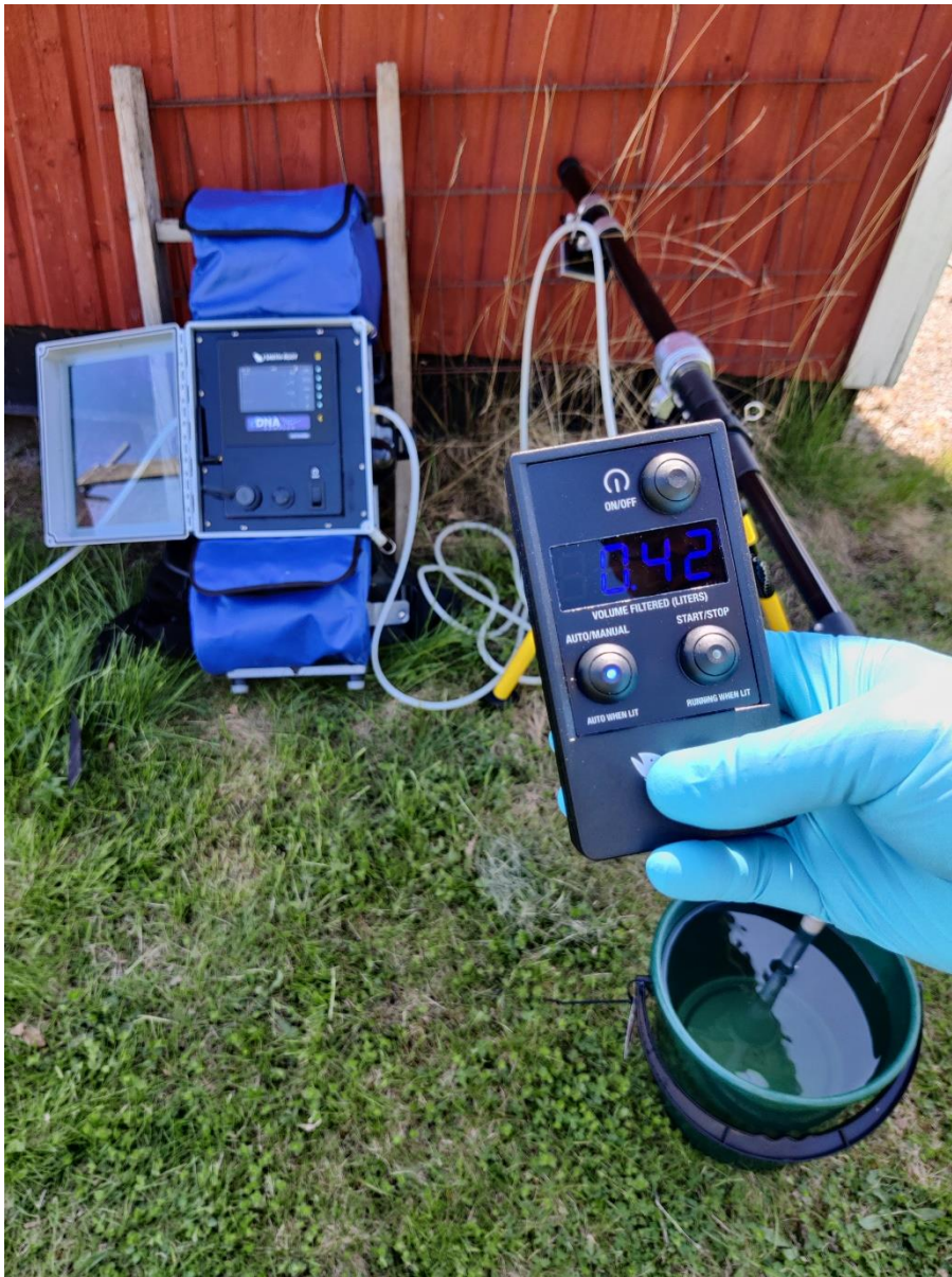
Kuva 5. eDNA-näytteenotossa käytetty pumpullinen reppukerääjä (Kuva Luonnonvarakeskus).
