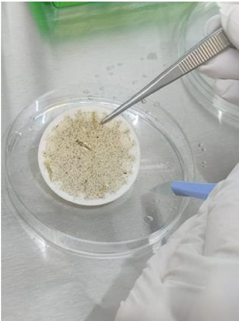
Kuva 6. DNA-eristyksessä käytetty keräysfiltri eristyskaapissa, kun suojakapseli on purettu ympäriltä (Kuva Luonnonvarakeskus).
