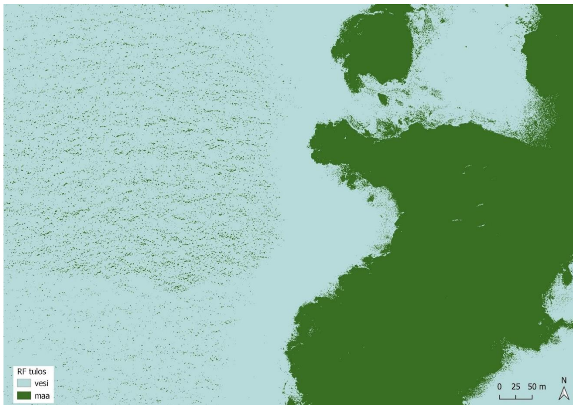
Kuva 6. Esimerkki aallokon aiheuttamista virheistä ilmakuvan luokittelussa.
