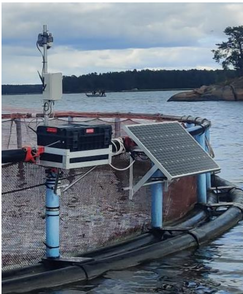
Kuva 1 Kalankasvatuslaitoksen verkkorakenteisiin asennettu kameralaitteisto kiinnitysjärjestelmineen.
