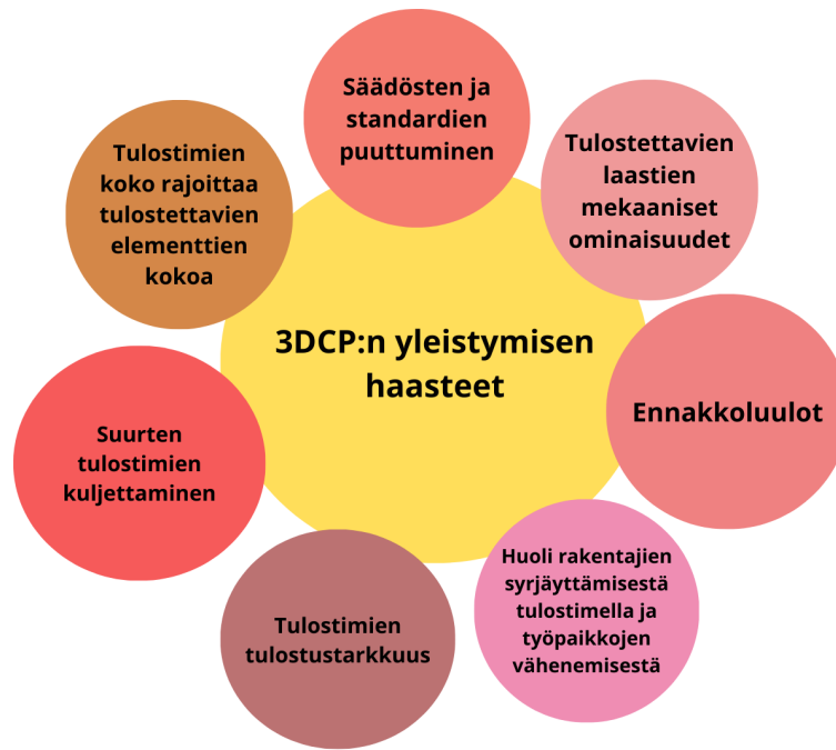
Kuva 6. Haasteita 3D-tulostettavan betonin yleistymiselle rakennustekniikkana.
