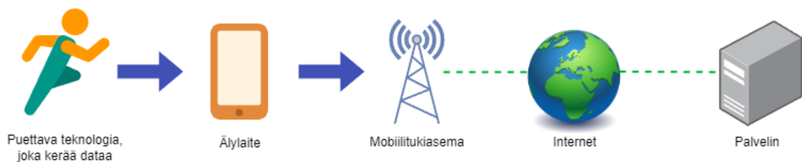
Kuva 3.1: Puettavan teknologian keräämän datan reitti palvelimelle [20].
