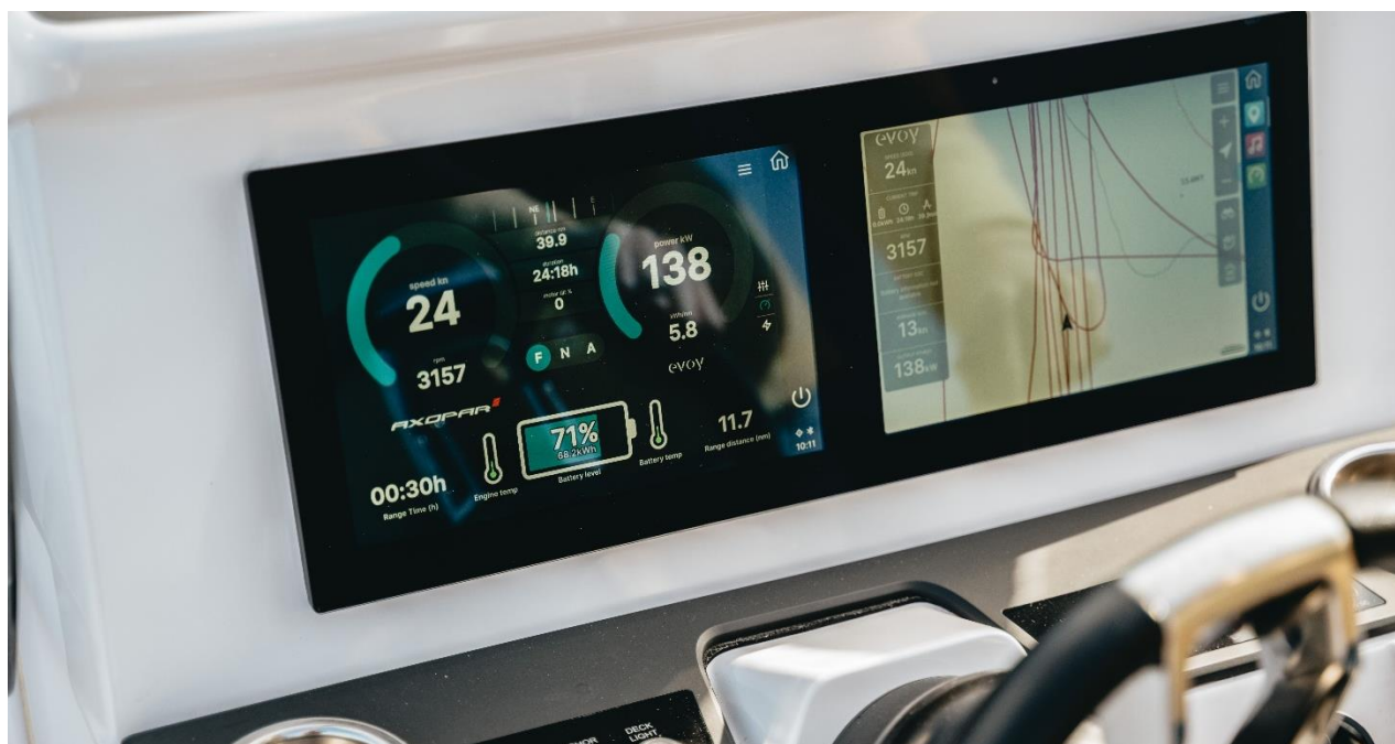
Kuva 6. Sähköllä toimivan veneen akkujen hallintapaneeli. Kuva: Evoy AS.
