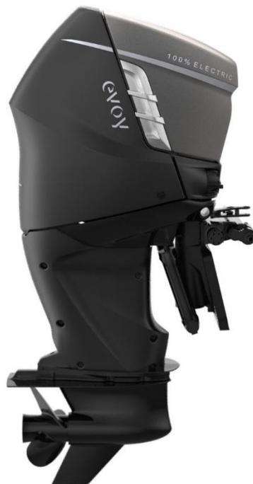
Kuva 5. Sähköllä toimiva ulkoperämoottori. Kuva Evoy AS.
