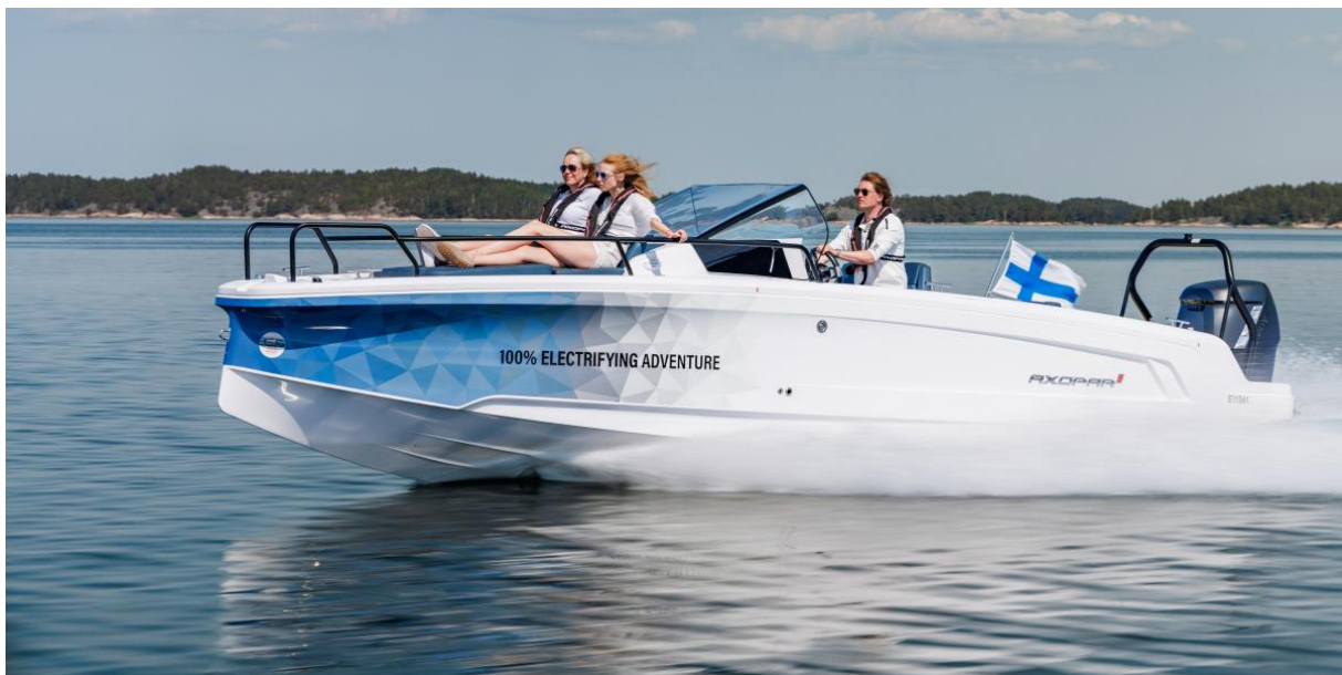
Kuva 13. Axopar 25 vene, joka on varustettu Evoyn sähköisellä ulkoperämoottorilla. Kuva Axopar Boats Oy.
