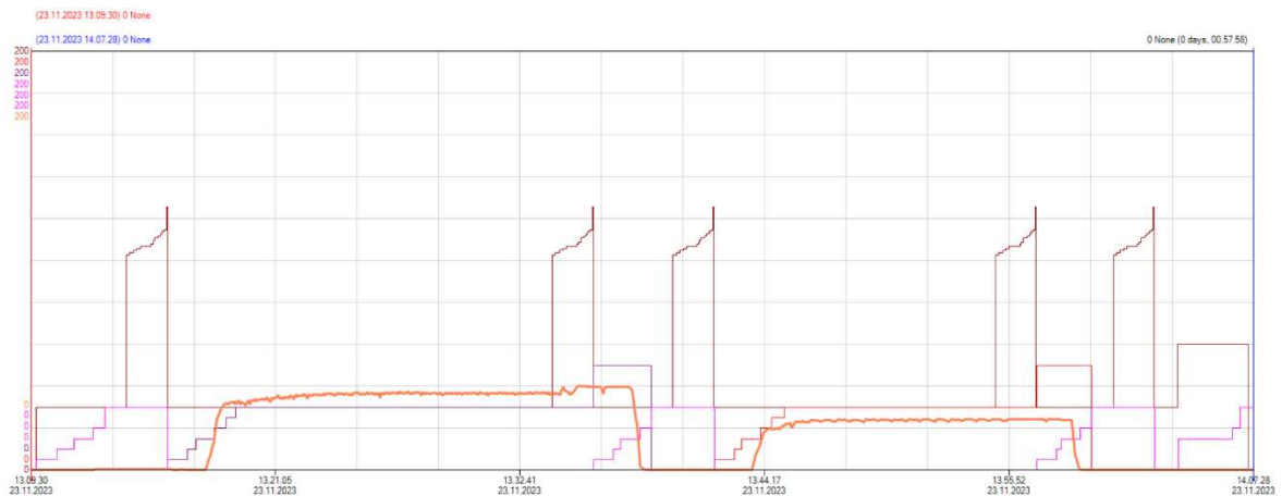
Kuva 10. Pesukohteen, L1CC02, emäshappopesun eteneminen ennen parametrimuutoksia. Johtokyky saavuttaa hyväksytyyn tason ennen varsinaisen huuhtelun alkamista sekä emäs- että happopesun jälkeen. Värien selitykset; ruskea=pesu, vaaleanpunainen=alku-, väli- ja loppuhuuhtelu sekä oranssi= johtokyky.
