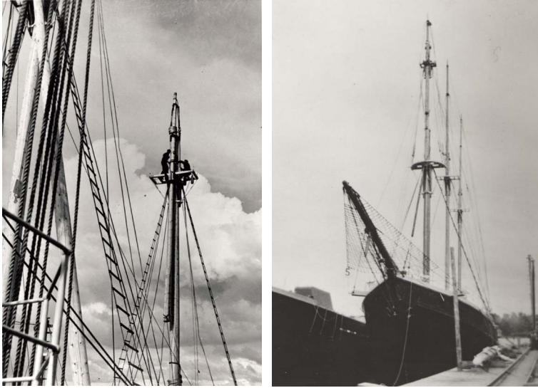
Kuvat 71–72. Vasemmalla tonkipuuta nostetaan, oikealla etualalla liiverpuomi verkkoineen. Kuvat RMA.
