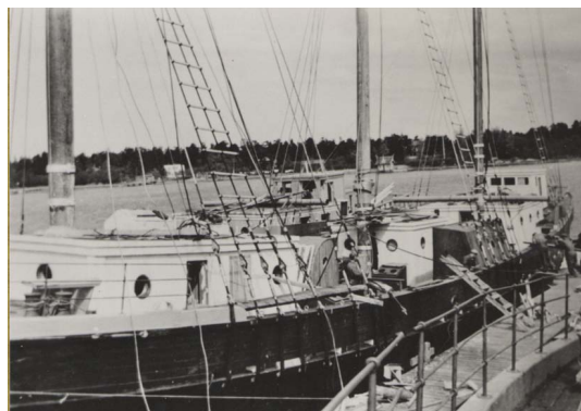
Kuva 73. Koululaivan kyljessä on rostiraudat, joihin vantit kiinnitettiin. Kuva RMA.
