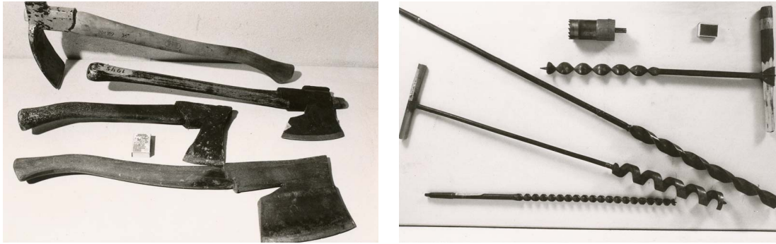
Kuvat 56–57. Vasemmalla kirveet alhaalta: piilukirves, pikikirves (käytetty pikitynnyrin avaamiseen ja pien rikkomiseen), väärävarsikirves ja leksi. Oikealla erilaisia poranteriä, joita tarvittiin paljon. Kuvat Sirpa Wahlqvist.
