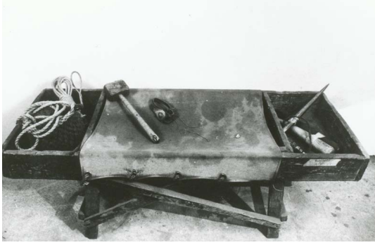
Kuva 79. Seilimaakarin penkki ja työvälineet, penkillä purjehanska ja purjeen palteen taivuttamisessa käytetty saumausvasara. Kuva Sirpa Wahlqvist.
