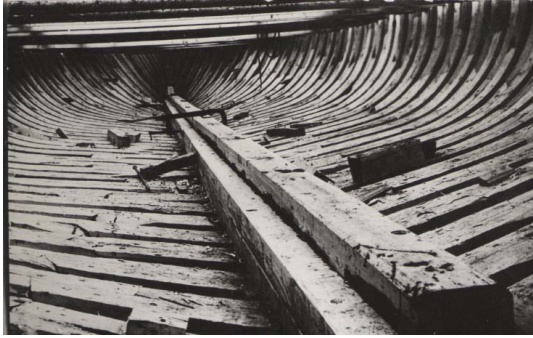
Kuva 43. Sikoköli ja sivusikokölit. Kuva RMA.
