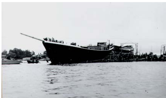
Kuvat 62–63. Vasemmalla sotakorvauskuunarin vesillelasku keula edellä. Laiva on ilmeisesti juuttunut kiinni ja sitä yritetään irrottaa. Oikealla (etualalla) rullatelakka. Kuvat RMA.
