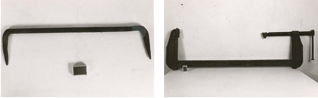
Kuvat 58–59. Vasemmalla hollihaka ja oikealla kuunarityömaalla käytetty puristin, jolla on mittaa 130 cm. Kuvat Sirpa Wahlqvist.
