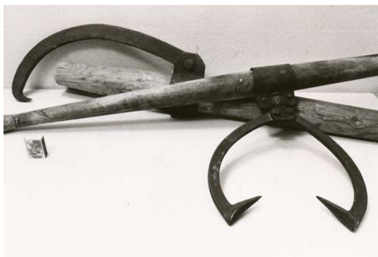
Kuva 26. Kuunaripuiden siirtelyssä käytettyjä tukkisaksia. Kuva Sirpa Wahlqvist.
